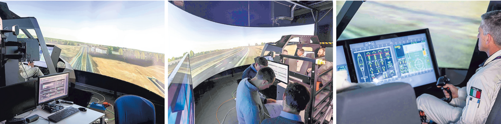
Sopra, tre momenti dell'attività all'interno di uno dei due Digital Lab di Leonardo, dove grazie all'attività di simulazione è possibile far operare i gemelli digitali degli elicotteri in produzione, e progettare i futuri modelli
