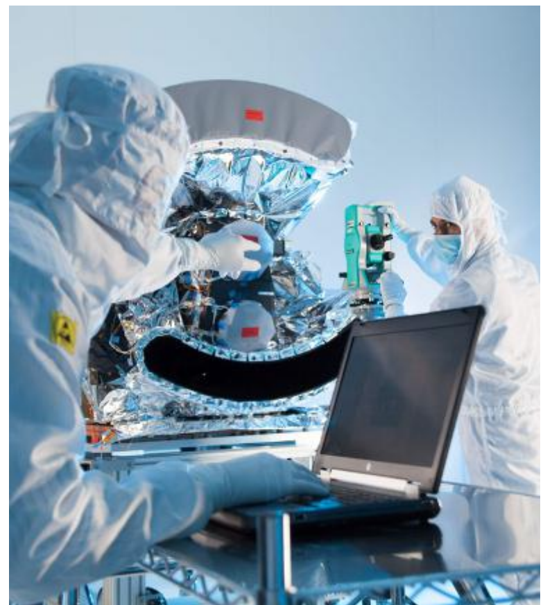
Lo strumento SLSTR in grado di misurare da 800 km di altezza la temperatura degli oceani e della terra con una precisione di un decimo di grado (foto di Mario Guerra)
