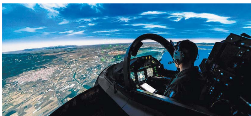
Il Full mission simulator che riproduce virtualmente il velivolo M-346
